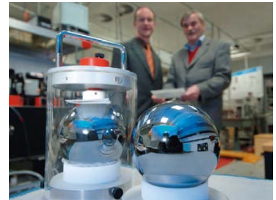
esferas casi perfectas de ^{28}\text{Si} (cada una con una masa de 1 kg)
