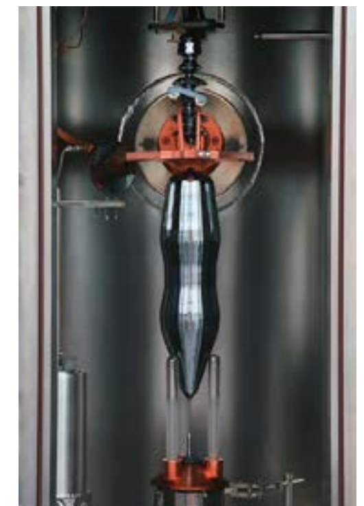
Monocristal de 4,7 kg de ^{28}\text{Si} altamente enriquecido
